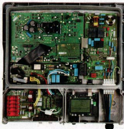
Interne Lösung: Bei den »Tripower«-Wechselrichtern von SMA kann ein gleichstromseitiger Überspannungsschutz auf vormontierte Steckplätze (rote Fläche unten links) gesetzt werden
